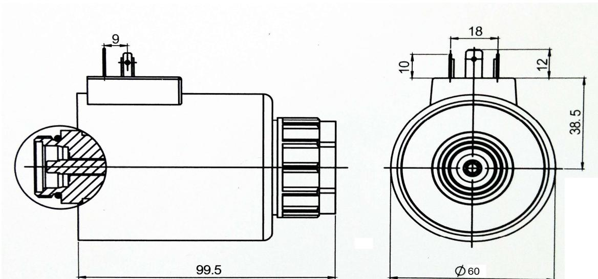
**Diâmetro Interno Bobina: 31,6mm**
