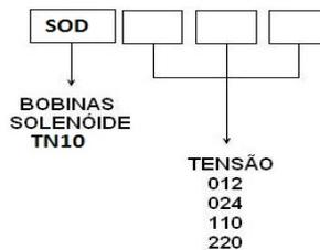
**Composição do kit SOD = Bobina + Plug DIN EN 175 301-803 com LED
